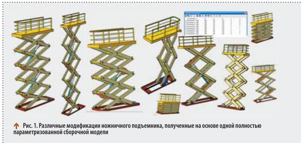
↑ Рис. 1. Различные модификации ножничного подъемника, полученные на основе одной полностью параметризованной сборочной модели
