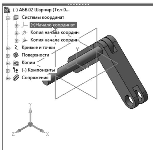
Сборка сразу займет правильное и полностью определенное положение относительно *Штифта* с помощью единственного сопряжения.
