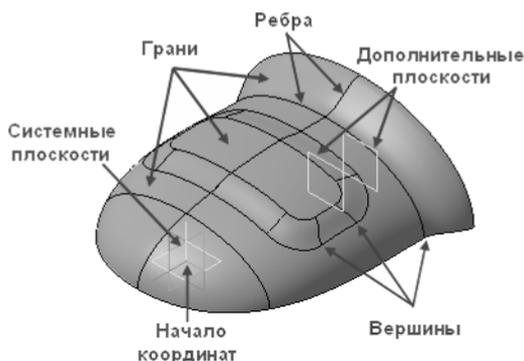
**Грань** — гладкая (необязательно плоская) часть поверхности детали. Гладкая поверхность детали может состоять из нескольких граней.
