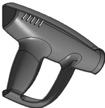
Деталь создается как поверхностная модель нулевой толщины, которая затем преобразуется в твердотельную тонкостенную модель. Используя твердотельную модель как заготовку, можно получить левую и правую половины корпуса со всеми необходимыми дополнениями и собрать модель изделия.
