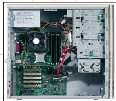
Графическая рабочая станция Arbyte CADStation изнутри
