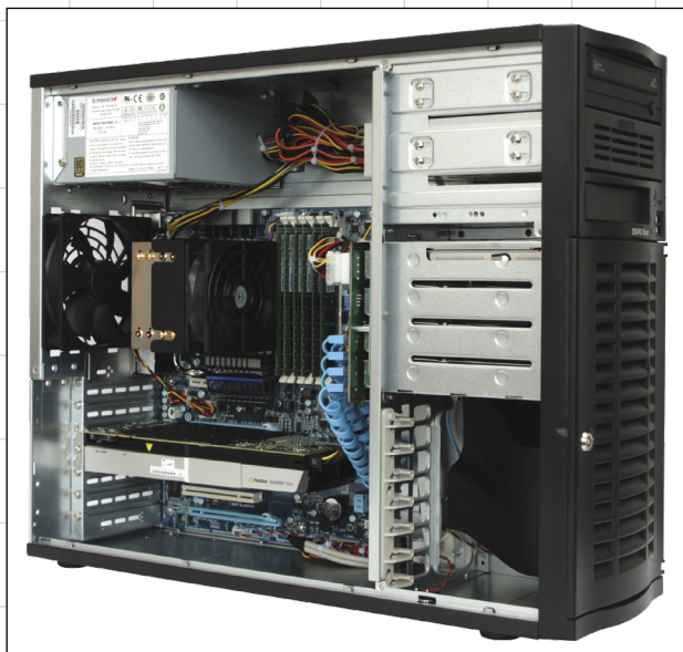
Во всех графических станциях DEPO Race система охлаждения внутренних элементов базируется на маломощных управляемых вентиляторах, которые эффективно отводят теплый воздух из корпуса. Фото предоставлено производителем.
