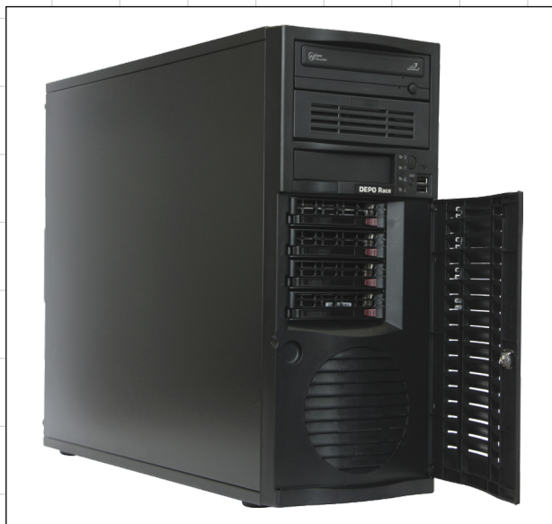
Дисковая подсистема DEPO Race G640S соответствует современным требованиям к надежности и производительности: до четырех жестких дисков в корзине с «горячей» заменой и поддержка RAID-массивов
